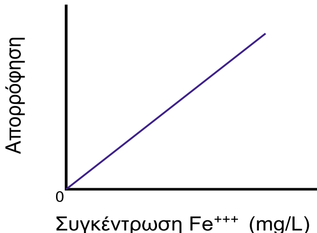
Εικόνα 4.4.2 Καμπύλη αναφοράς για το \text{Fe}^{+++} .
